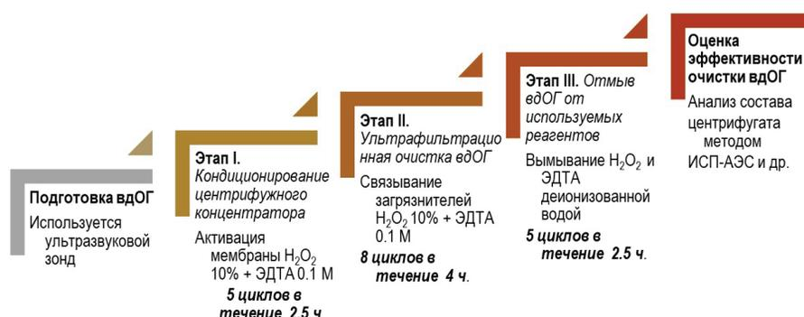
Рис. Этапы ультрафильтрации для очистки водных дисперсий оксида графена.
