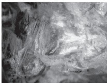
Рис. Иллюстрация игольчатой формы кристаллов образца
